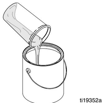
6. Вставьте новую подкладку в бачок и наполните соответствующей промывочной жидкостью на 1/ от общего объема. Закрутите крышку и подсоедините бачок к распылителю. Встряхните распылитель, чтобы распределить внутри него промывочную жидкость и очистить все смачиваемые поверхности внутри бачка.
