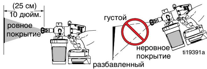
Сгибайте запястье, чтобы удерживать распылитель под прямым углом. Распыление под углом приводит к образованию неровного покрытия.
