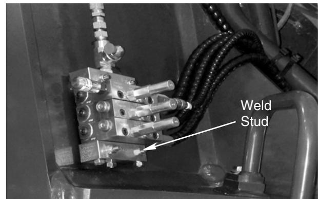
**FIG. 1: Weld Stud Anchor**
