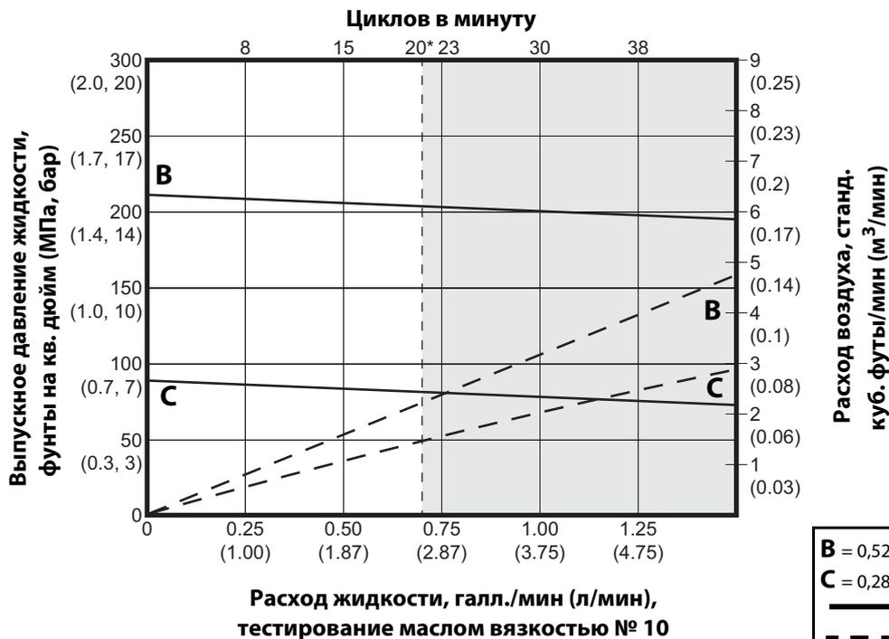
**Пневматический двигатель (2,5 дюйма) с соотношением в нижнем насосе 6:1
