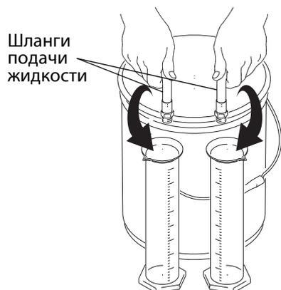
Рис. 4. Проверка соотношения смешивания
